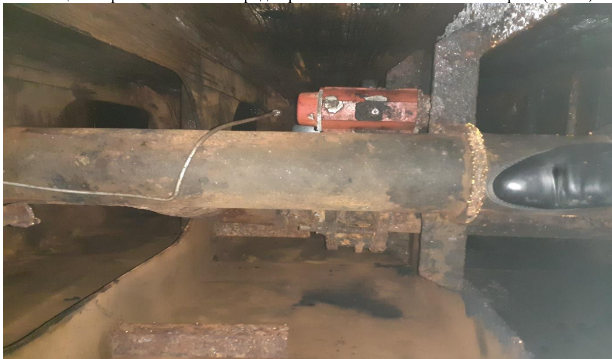
(Фиг.3) Общ вид на шпилките на крана на баластния тръбопровод (поглед отгоре)
