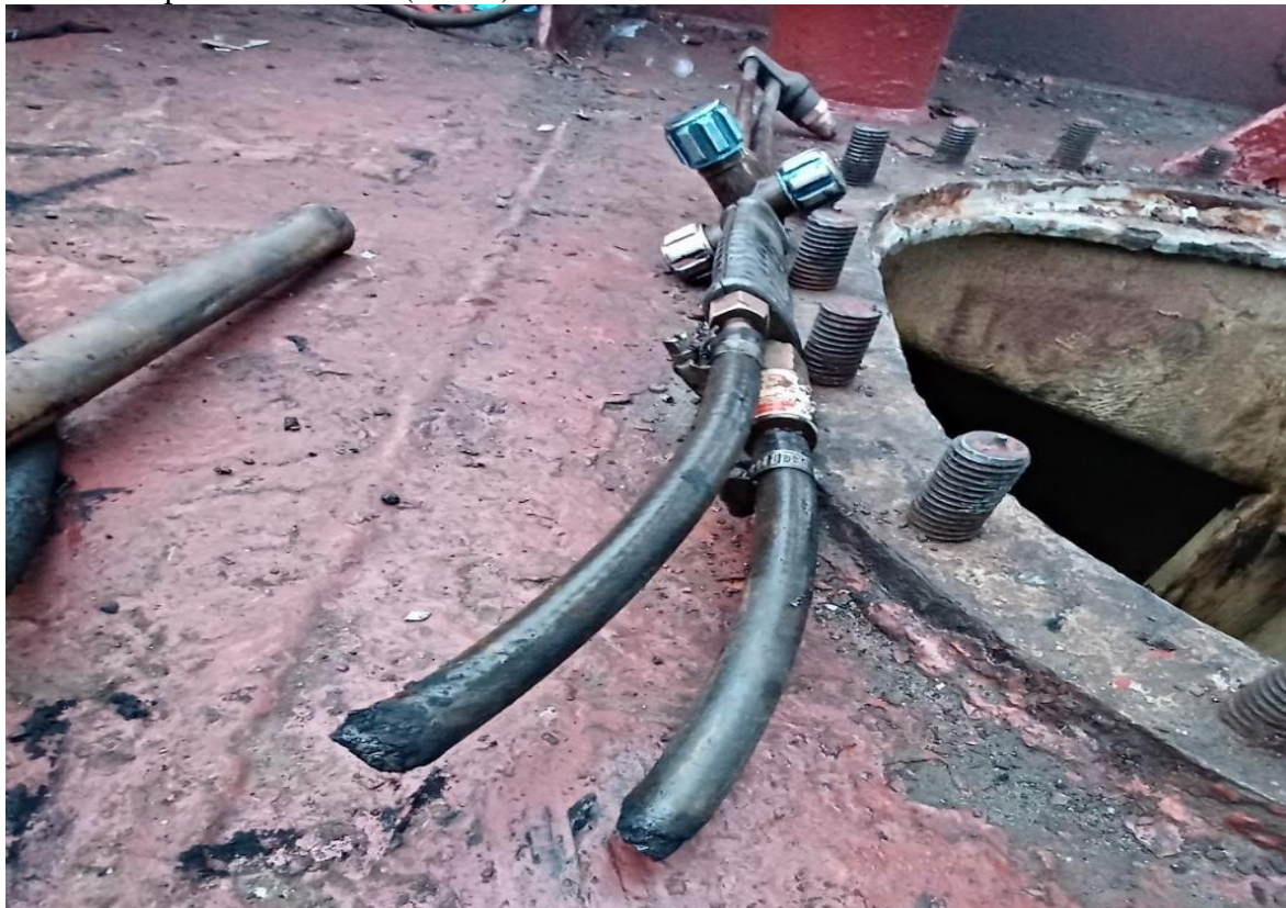
Фиг.4 - Използваният резач с обгорелите шлангове
