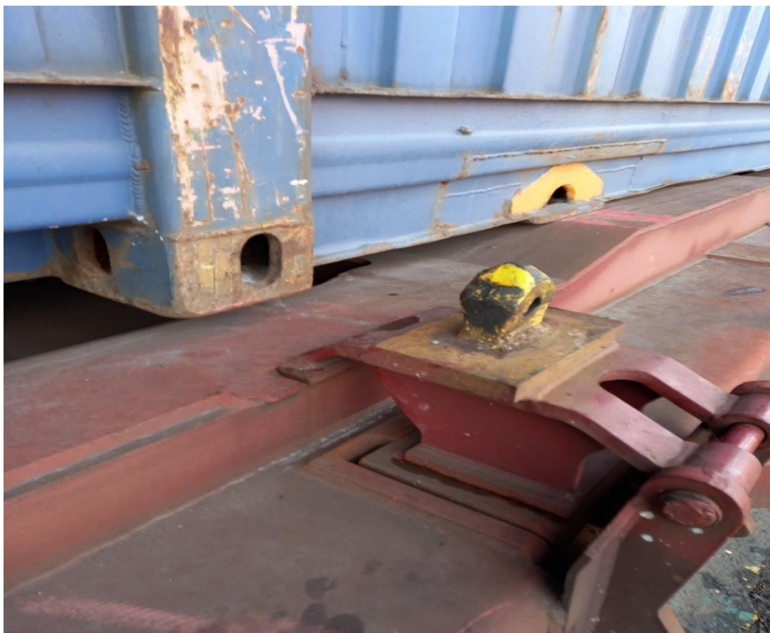
Фиг. 4.13. Изместен контейнер от петата на вагона.
