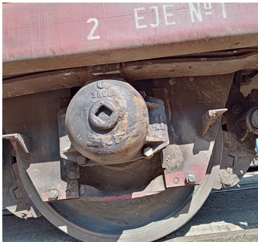
Фиг. 4.18. Дясно колело с оригинален ресор.
