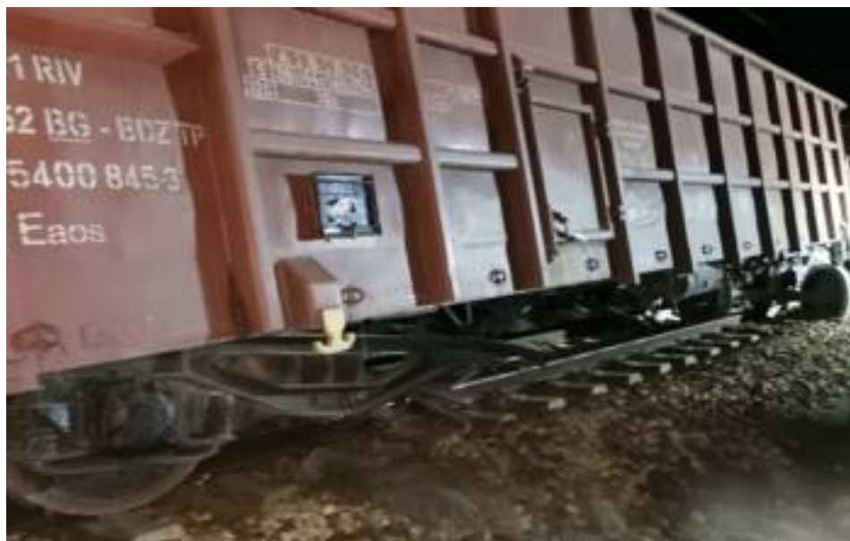
Фиг. 1.1. Дерайлирала първа талига на вагон № 31525400845-3 в междугарието Шивачево – Твърдица
