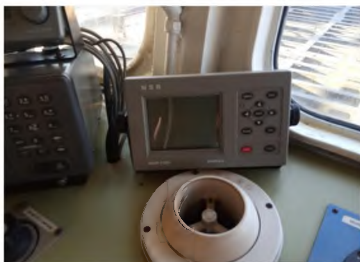
Фиг. 5 – Управляващ модул на навигационната система за контрол на вахтения на мостика
