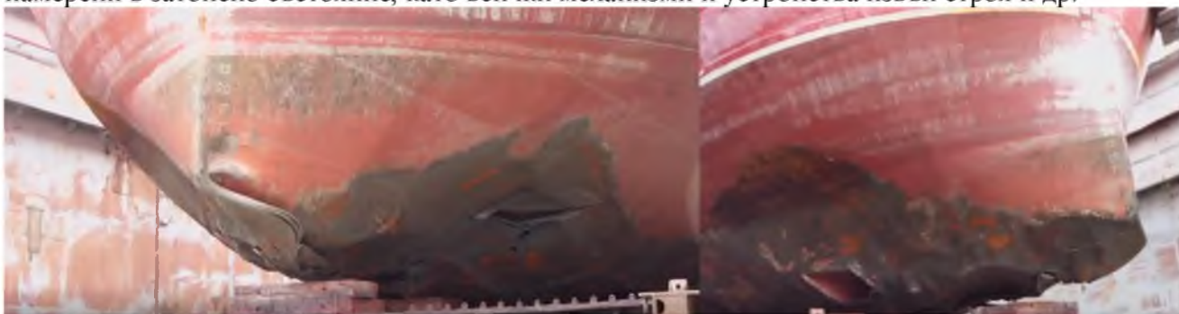
Фиг. 14 Поражения на кораба в носовата част (лев и десен борд)
