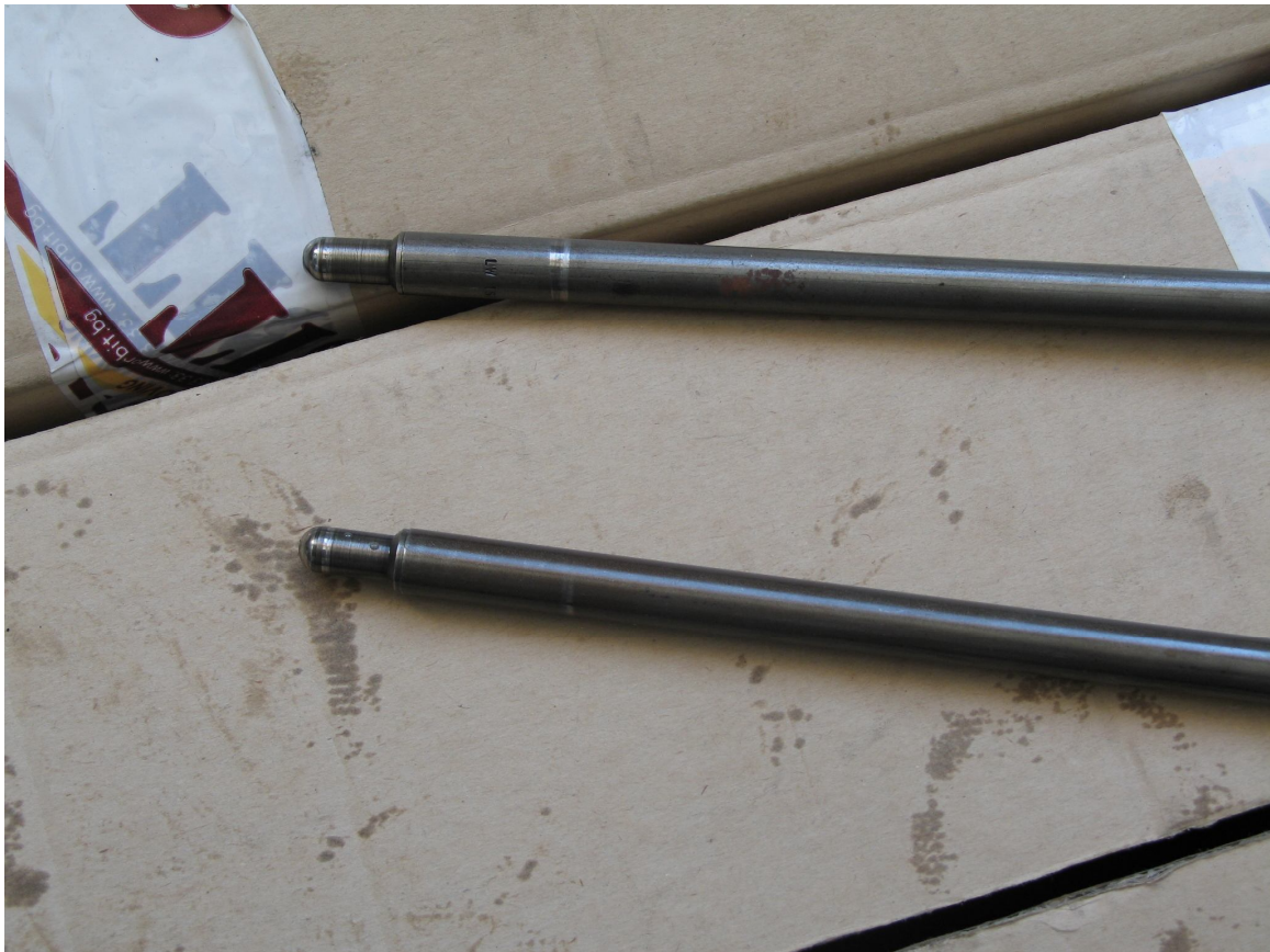
Фиг. 9. Износване по повдигачите на кобилиците на клапаните на четвърти цилиндър.
