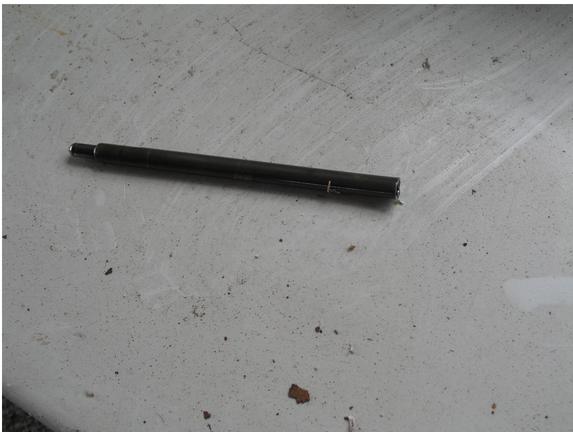
Фиг. 4. Разрушения повдигач на кобилицата на изпускателния клапан на трети цилиндър.
