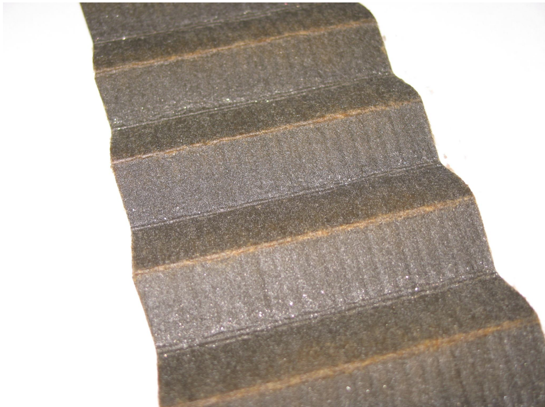
Фиг. 10. Парче от филтъра с полепнали стружки.
