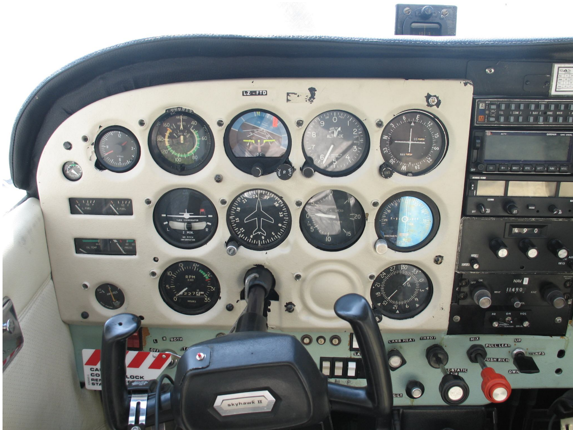
Фиг. 11. Снимка на приборното табло на ВС на която се вижда скоростмера, указателят на вертикалната скорост и превключвателят на позицията на клапите.
