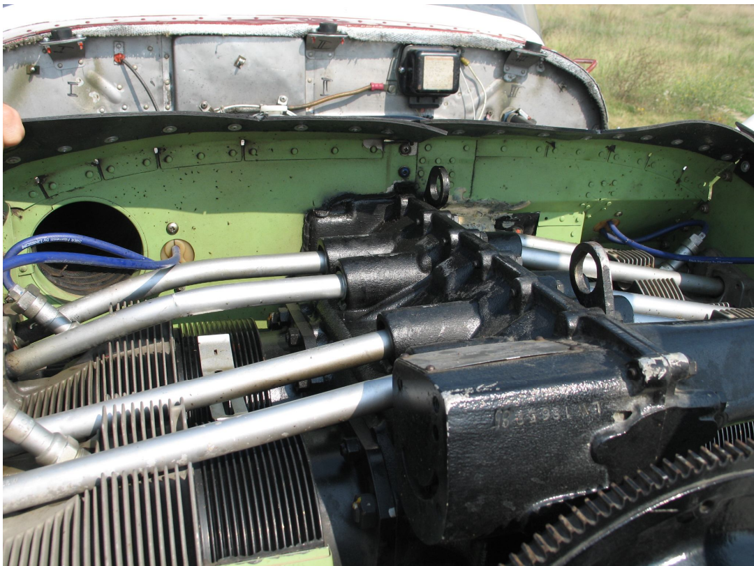
Фиг. 2. Поглед към изкривените водачи на повдигачите на кобилицата на клапаните на трети цилиндър на двигателя.
