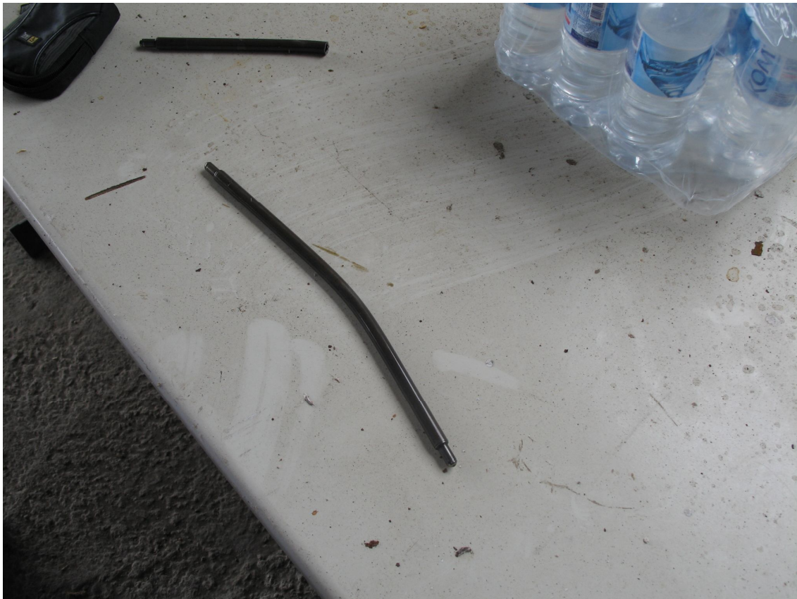
Фиг. 5. Изкривен повдигач на кобилицата на смукателния клапан на трети цилиндър.
