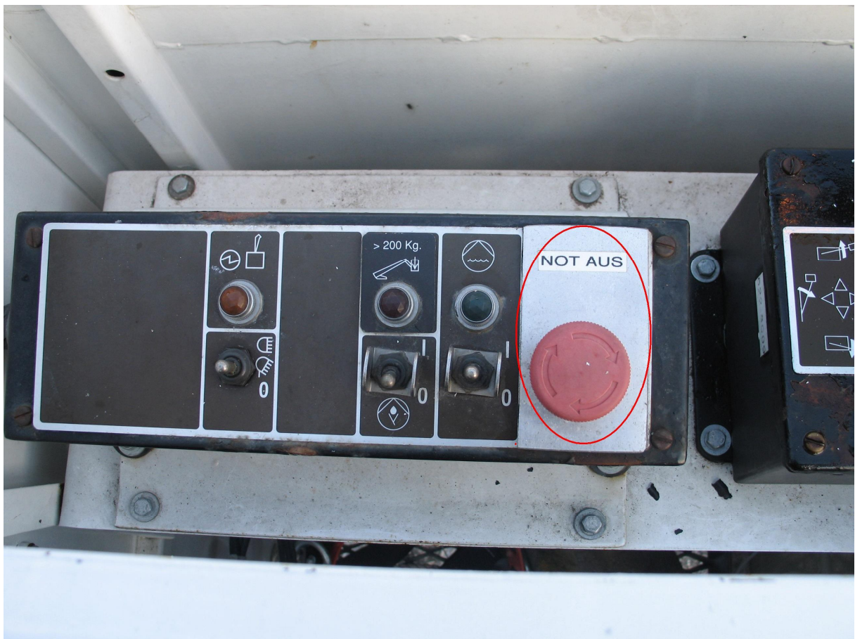
Фиг.8. Аварийен „стоп-бутон” в коша на автомобила.
