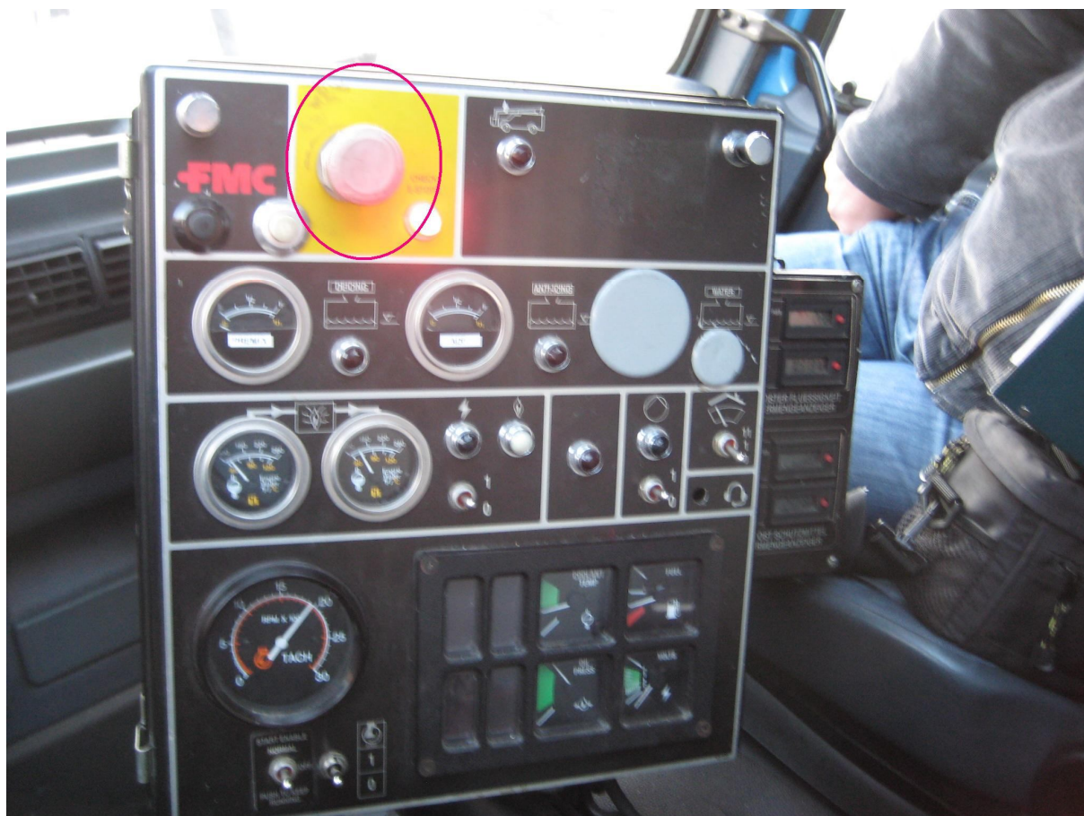
Фиг.9. Пулт за управление на системата за пръскане в кабината на камиона с аварийен „стоп-бутон”, ограден в червено.
