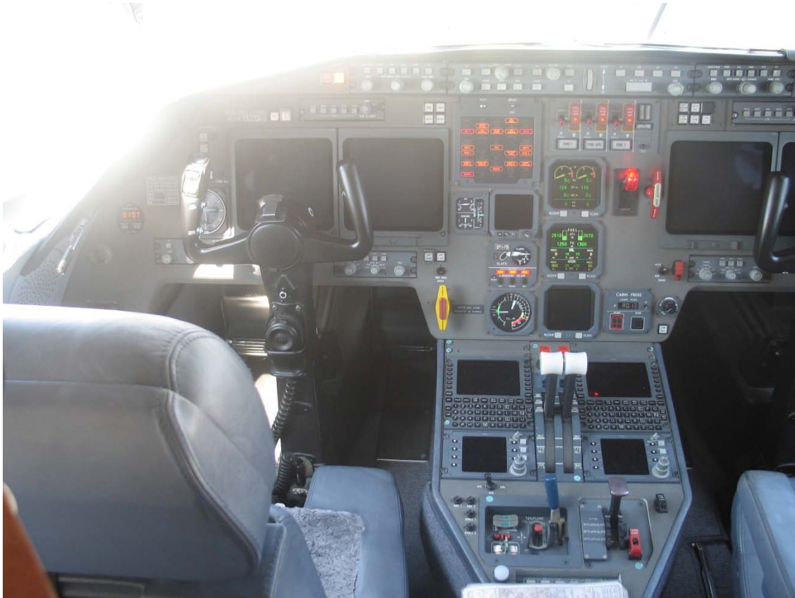
Фиг. 13. На конфигурационния панел светят три червени светлини.
