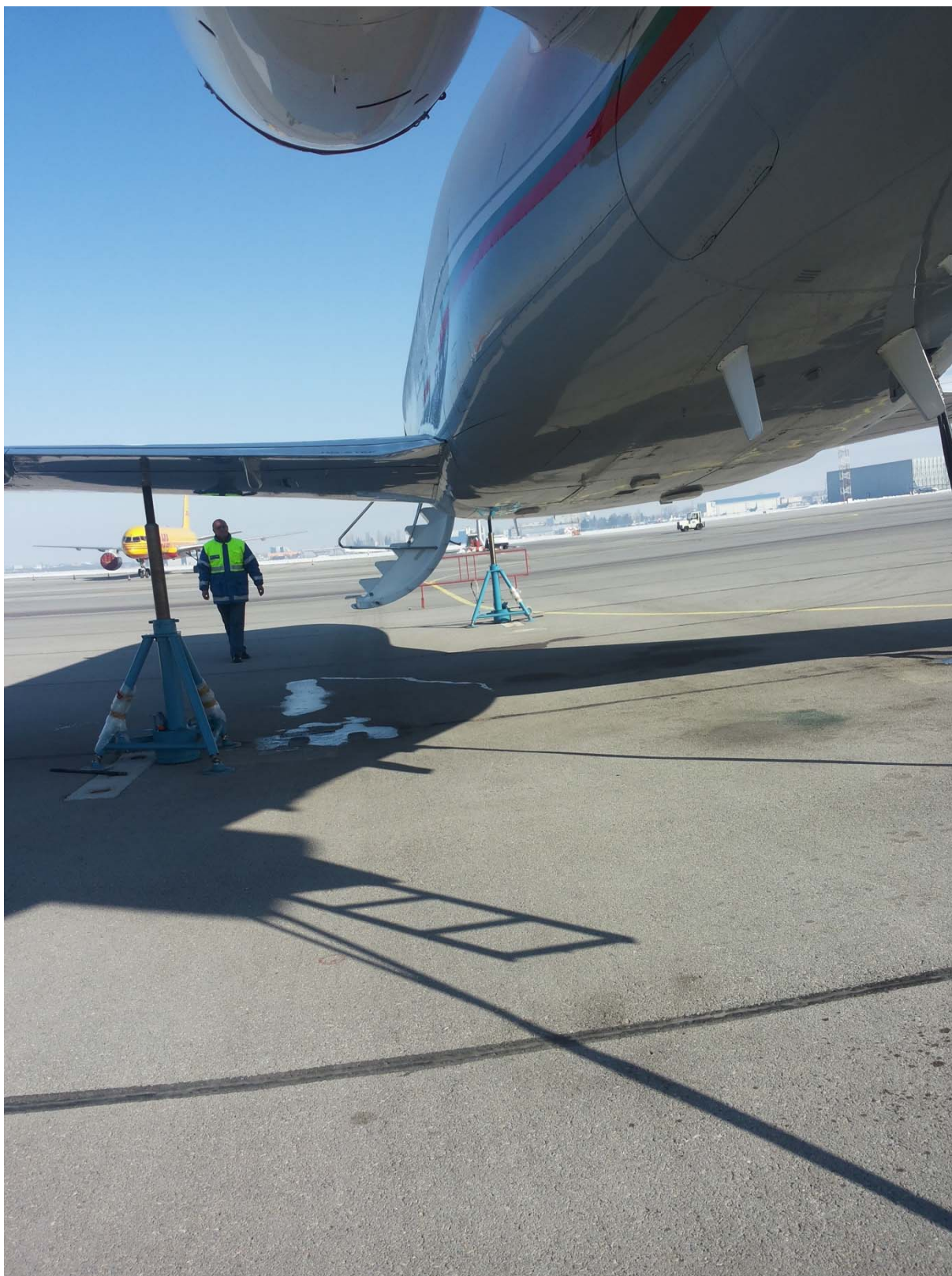
Фиг. 8. Самолетът с прибран колесник при изпитания на 13.02.2015 г.
