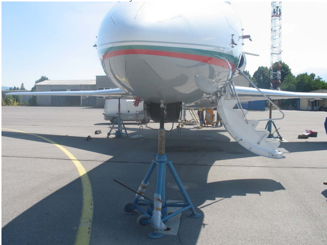
Фиг. 12. Ръчката е на прибрано положение, носовата стойка не е заключена в прибрано положение.
