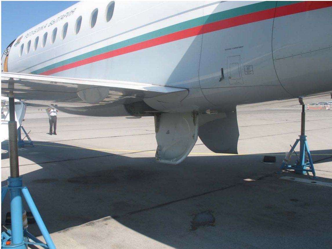
Фиг. 11. Ръчката е на прибрано положение, щитките на основните колела остават в пуснато положение.
