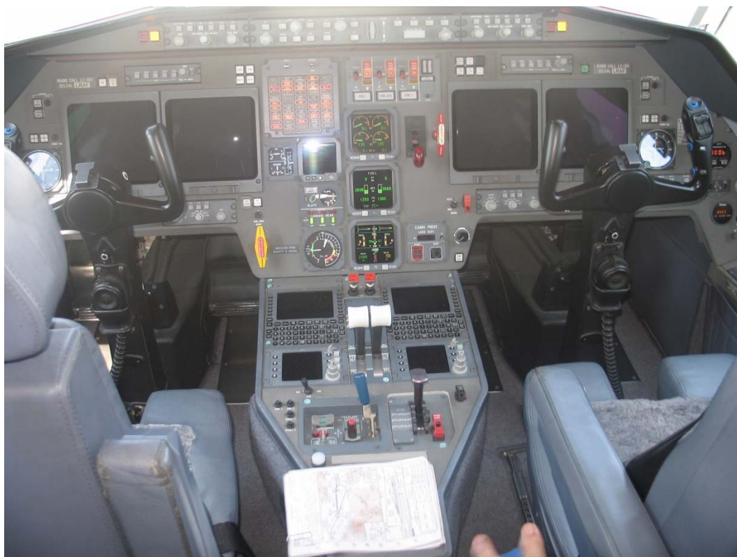
Фиг. 10. Сигнализация за пуснато положение на колесника на конфигурационния панел.
