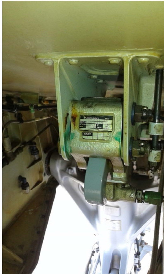
Фиг. 14. Отказалата ключалка на носовия колесник.
