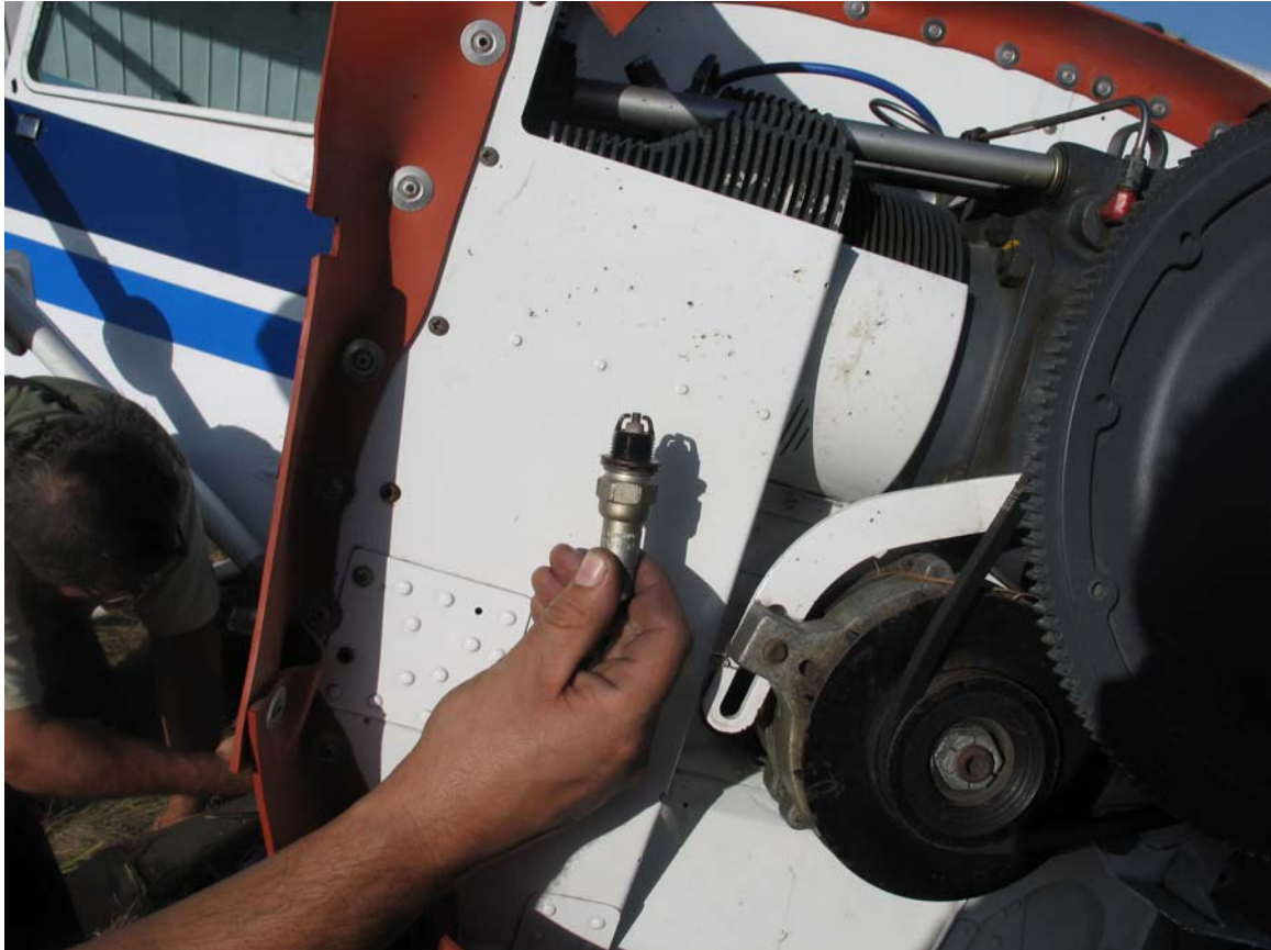
Фиг. 21. Долна свещ от трети цилиндър.
